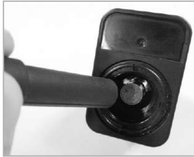
(2) LED 램프 교체 공구로 LED 램프에 삽입한다. (Insert it into Lamp of LED with remover.)
