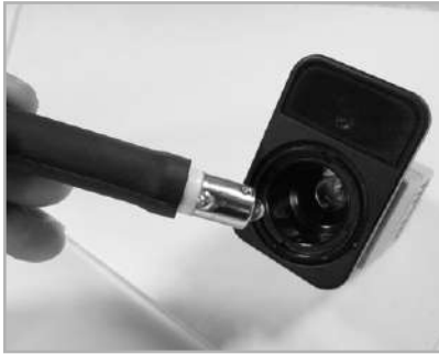
(4) 분해 역순으로 LED 조립한다. (Inverse order of assemble in order to assemble LED.)
