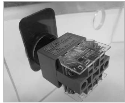
(3) 접점부를 홀다부에 밀어 끼운다. (Push the contact part into the holder part.)
