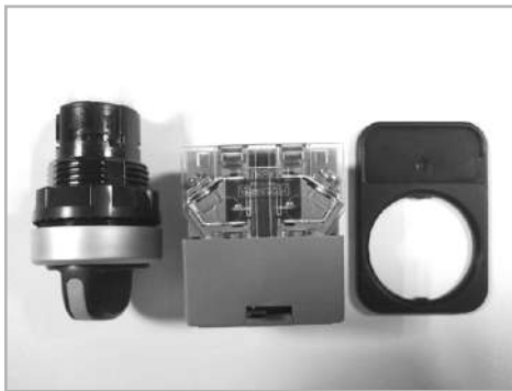
(1) 접점부 레바를 밀어 홀다부 분리한다. (Push the contact part, and then separate the holder part from contact part.)
