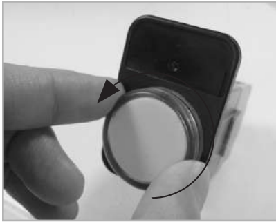
(1) 전면캡 반시계 방향으로 회전하여 캡을 제거한다. (Remove the CAP to turn counterclockwise.)
