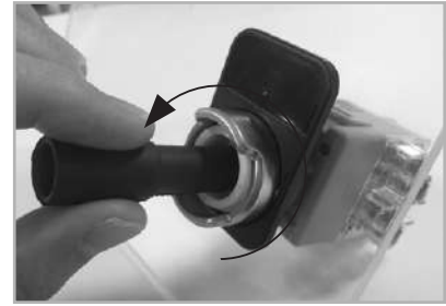
(3) LED 공구를 누른 후 반시계 방향으로 회전시켜 LED 램프 분리한다. (Remove the LED lamp to press the LED too and turn it counterclockwise.)
