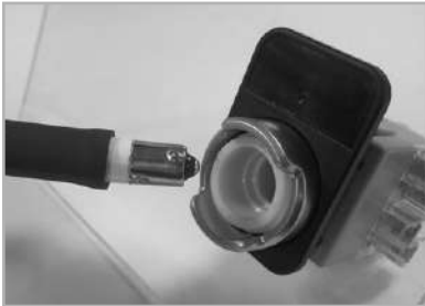
(4) 분해 역순으로 LED 조립한다. (Inverse order of assemble in order to assemble LED.)
