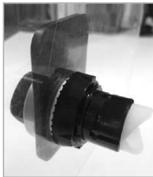
(2) 홀다부 체결링을 분리하고 명판을 끼운 후 판넬에 조립한다. (Disassemble the connecting ring and then assemble it into the panel.)
