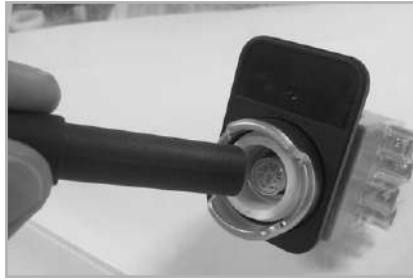
(2) LED 램프 교체 공구로 LED 램프에 삽입한다. (Insert it into Lamp of LED with remover.)
